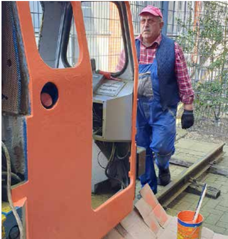
Unmittelbar nach dem Abschleifen der Roststellen wird Rostschutzfarbe aufgetragen.
